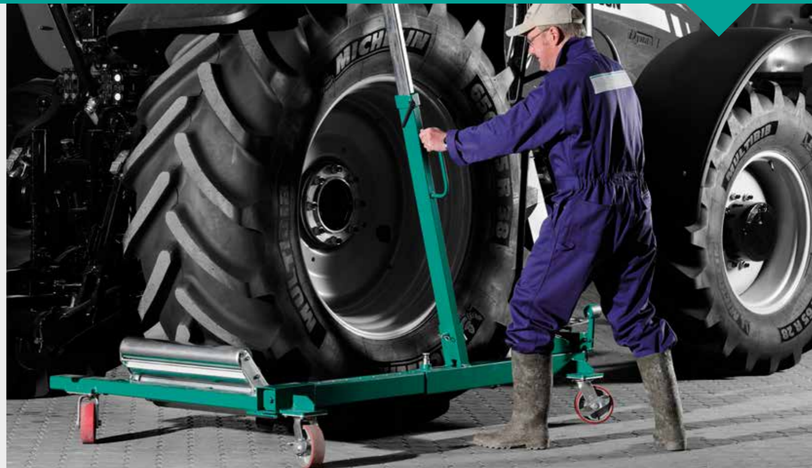
Let håndtering af store hjul med diameter fra 1250 mm op til 2400 mm og bredde op til 1050 mm.
