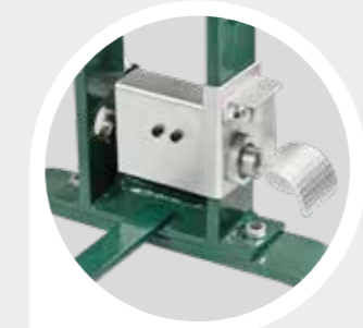
Hurtig, fodbetjent trykluftstyre fremføring af stempel.
